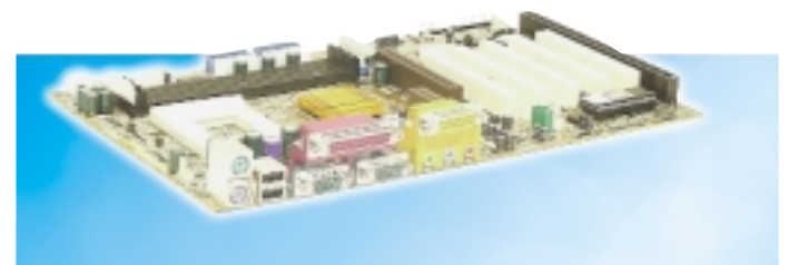
Lucky Star K7VAT, AMD Duron ve Thunderbird işlemcilerini destekleyen ve üzerinde KT133 chipseti olan bir anakart.
