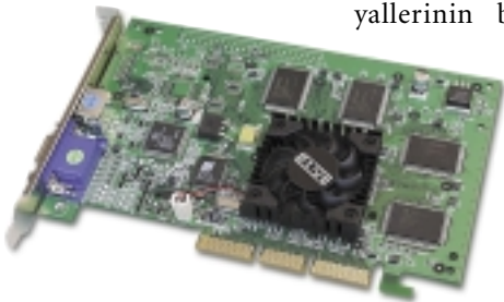
Mevcut grafik işlemcileri fazlaca ısındığı için soğutucuları üzerine genellikle bir fan takılır.
