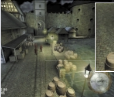
FSAA açıkken poligon kenarlarındaki tırtıklar yumuşatılır ve grafik kalitesi yükselir.
