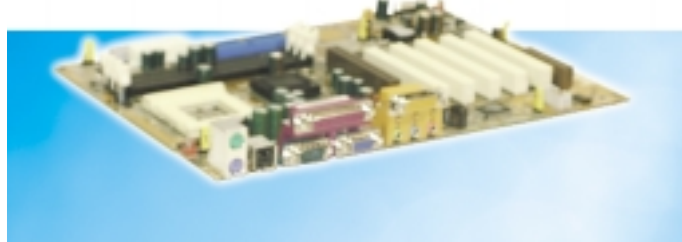
Bu anakart Intel'in yeni chipseti olan i815e'yi üzerinde taşıyor ve 300MHz ile 1 GHz arasında olan birçok işlemciyi destekliyor.
