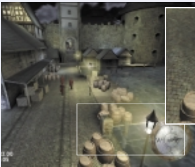
FSAA kapalıyken poligon kenarlarında yer alan tırtıklar oldukça belirgindir.
